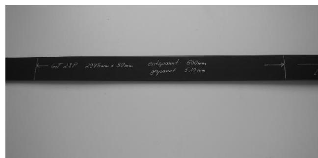
**Es ist zu beachten, dass die Riemenspannung nach den ersten 100 Betriebsstunden überprüft und ggf. nachgespannt werden muss.**
