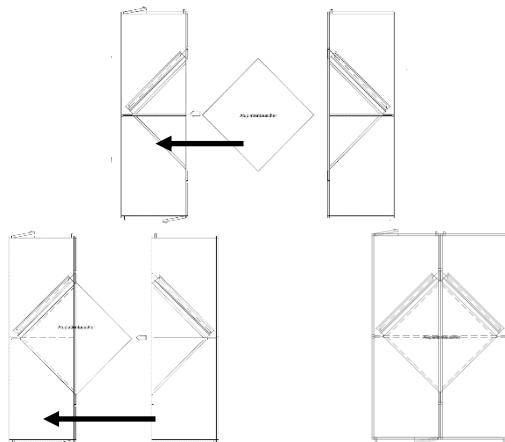
Die vormontierten Geräteverbindungen nicht zum Zusammenziehen der Module verwenden! Diese können bei Überbelastung ausreißen oder das Gerät deformieren.
