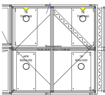
Auch hier nach erfolgter Montage sind die Stoßstellen zwischen Plattenwärmeübertrager und Gehäuse mit Dichtstoff abzudichten.
