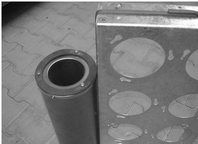
Um eine einwandfreie Funktion der Filterpatronen zu gewährleisten ist eine Geruchsprüfung nach den Filtern durchzuführen. Gegebenenfalls sind die Patronen auszuwechseln.
