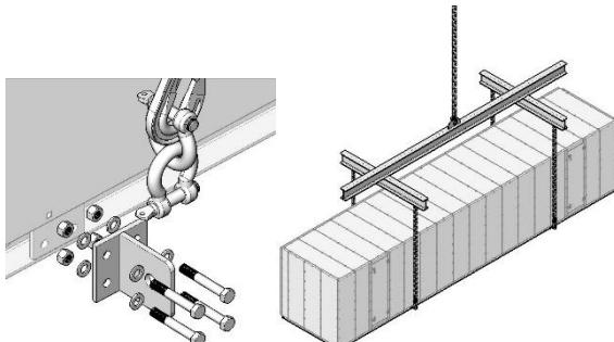
Maximal zulässige Gewichtsbelastung pro Modul 3500 kg (leichte Ausführung) bzw. 8000 kg (schwere Ausführung)
