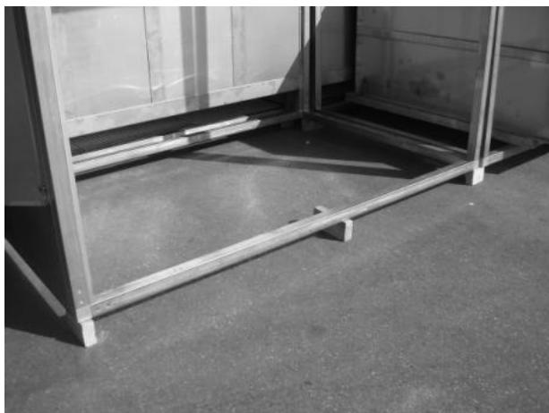
In und auf die Bauteile dürfen keine fremden Teile/Kleinteile gelagert werden. Bewegliche Teile, wie Ventilator, Rotationswärmetauscher, Türen, etc. sind vor ungewollter Bewegung zu sichern. Die Bauteile dürfen nicht im Gefahrenbereich von anderen Maschinen gelagert werden.
